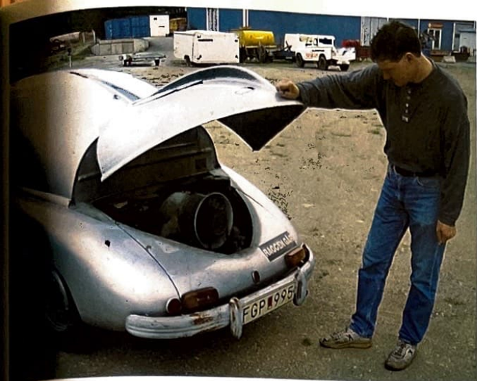
Motorn bak, en luftkyld 4-cyl boxer med toppventiler, volym 1 950 cc.
