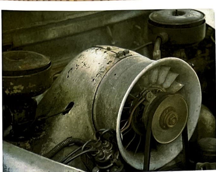
Motorn bak, en luftkyld 4-cyl boxer med toppventiler, volym 1 950 cc.
